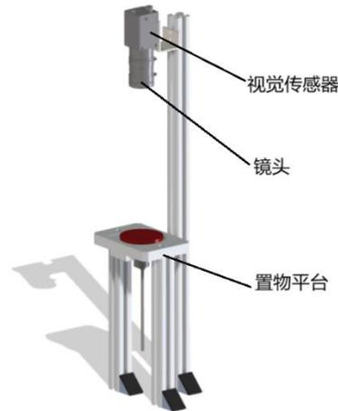
图 4 视觉检测系统示意图
